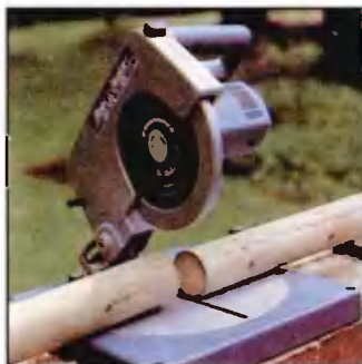
Жерди раскраивают по длине торцовочной пилой. В 10 см от торцов сверлят отверстия под болты. Для подвески «люстры» используют оцинкованную цепь.
